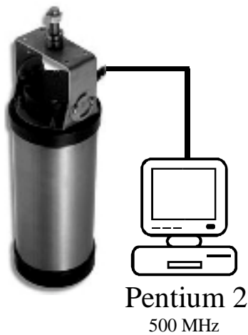
Abbildung 3-12: Anschluß des Sensors KALESTO
