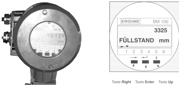
Abbildung 3-16: Steuerung der Radar-Sensoren BM100
