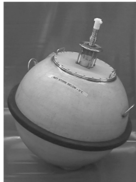
Abbildung 2-4: Seegangsmeßboje WAVERIDER [DATAWELL BV, 2000]
