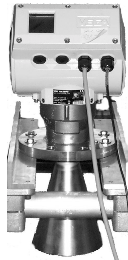
Abbildung 3-6: Ansicht des Radar VEGAPULS
