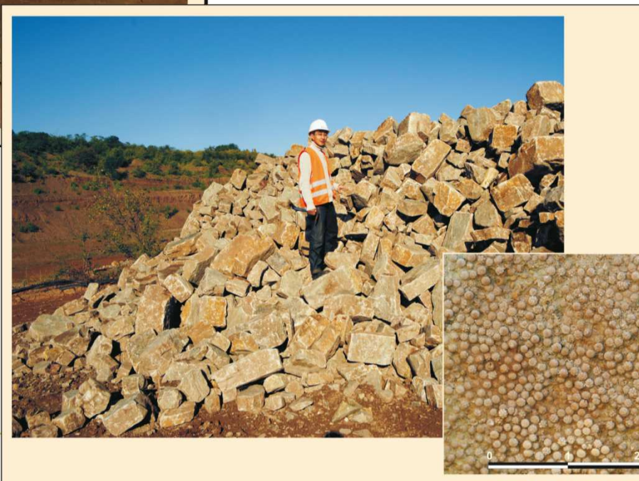
Abb. 11 Rogensteinabbau bei Beesenlaublingen (Könnern). Der Gesteinsname erklärt sich wegen seiner ausgeprägten Ooidstruktur, die an Fischrogen erinnert (Bild rechts unten). Noch heute sind die Bürgersteige zahlreicher deutscher Innenstädte, wie z.B. Berlin, mit diesem Material gepflastert.
