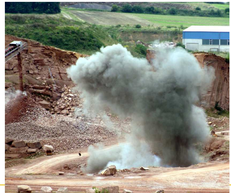
Rechts: Lösen eines Werkstein- blocks mit Schwarz- pulver im Steintagebau Löbejün.
