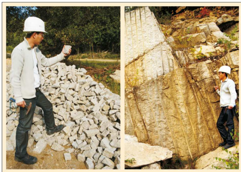
Rechts: Abbauwand im Steintagebau Holz Mühlental bei Flechtingen. Gut zu erkennen ist die ausgeprägte plattige Ablösung des vulkanischen Gesteins (Ignimbrit). Links: Abbau und Verarbeitung von Brockengranit im Steintagebau Knaupsholz bei Schierke. links: Herstellung von Pflastersteinen. Blick auf den anstehenden Werkstein. rechts: Gut erkennbar ist die z.T. weitständige natürliche Klüftung, die lokal die Gewinnung großer Blöcke ermöglicht.
