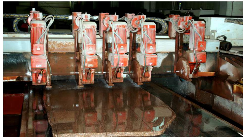
Formatieren von Werkstücken mit einer Multisäge in Löbejün.
