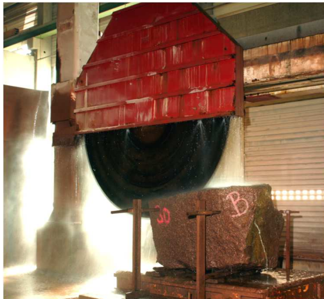
Oben: Blockkreissäge mit einem Blattdurchmesser von drei Metern in Löbejün.
