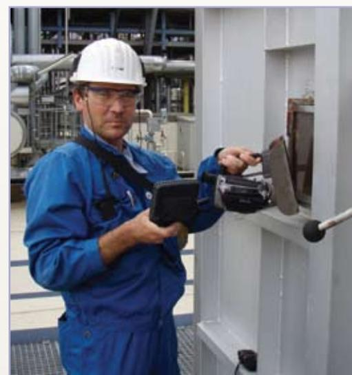
*Holger Springer mit seiner FLIR Kamera für Hochtemperaturanwendungen am Inspektionsfenster eines Ofens*
