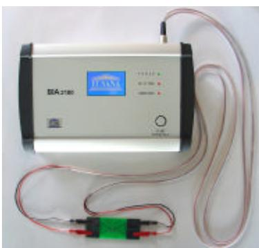
Über vier Hautklebelektroden wird ein homogenes elektrisches Feld hoher Frequenz (12 V, 50 kHz) in der zu messenden Person erzeugt. Gemessen wird der Widerstand (Impedanz) des Wechselstroms (800 Mikroampere) und dessen Phasenverschiebung gegen die Wechselspannung im Körpergewebe. Jeweils zwei der Elektroden werden an der Hand und zwei am Fuß derselben Körperseite befestigt.
