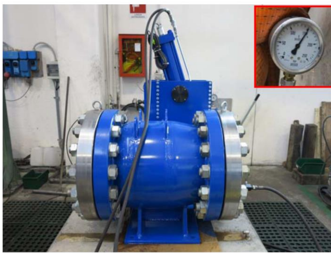
F600 PN100 HYDRAULISCHER TEST (PRÜFDRUCK = 150 BAR)
