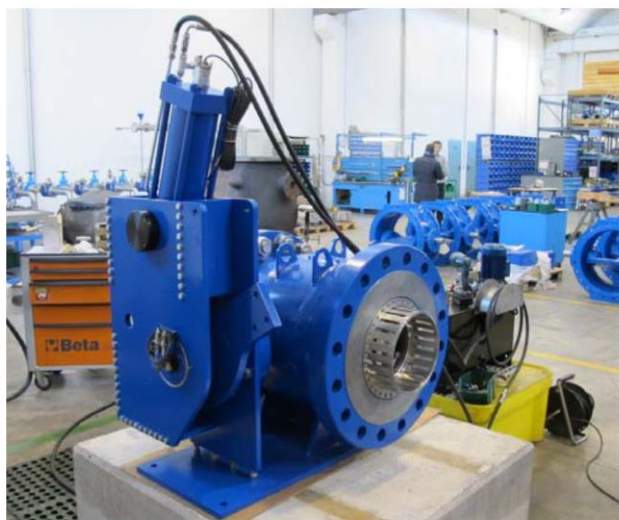
F600 PN100 HYDRAULISCHER TEST (PRÜFDRUCK = 150 BAR)
