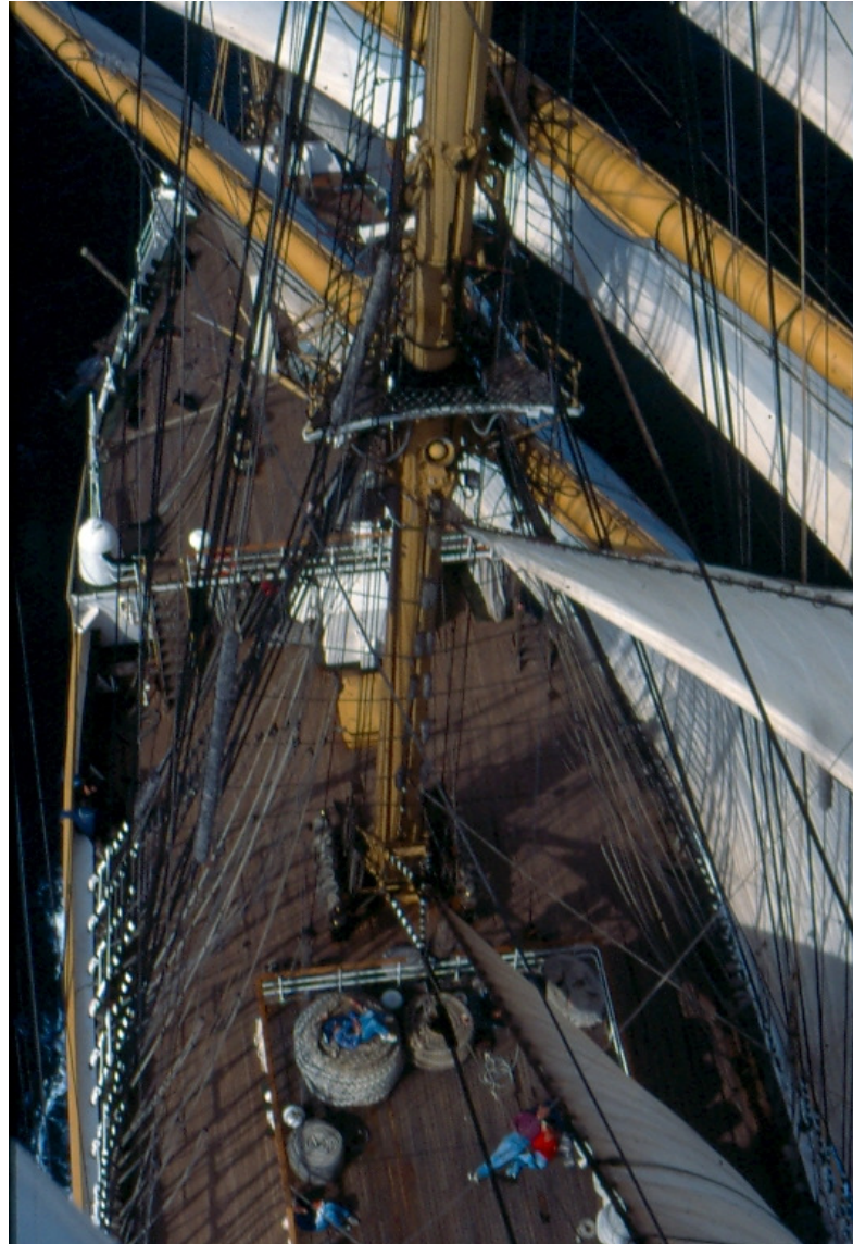
Unter Rigg wird die Takelage eines Segelschiffs bezeichnet, also alle Einrichtungen oberhalb des Decks, die dem Segeln dienen. (z.B. nicht Radareinrichtungen)
