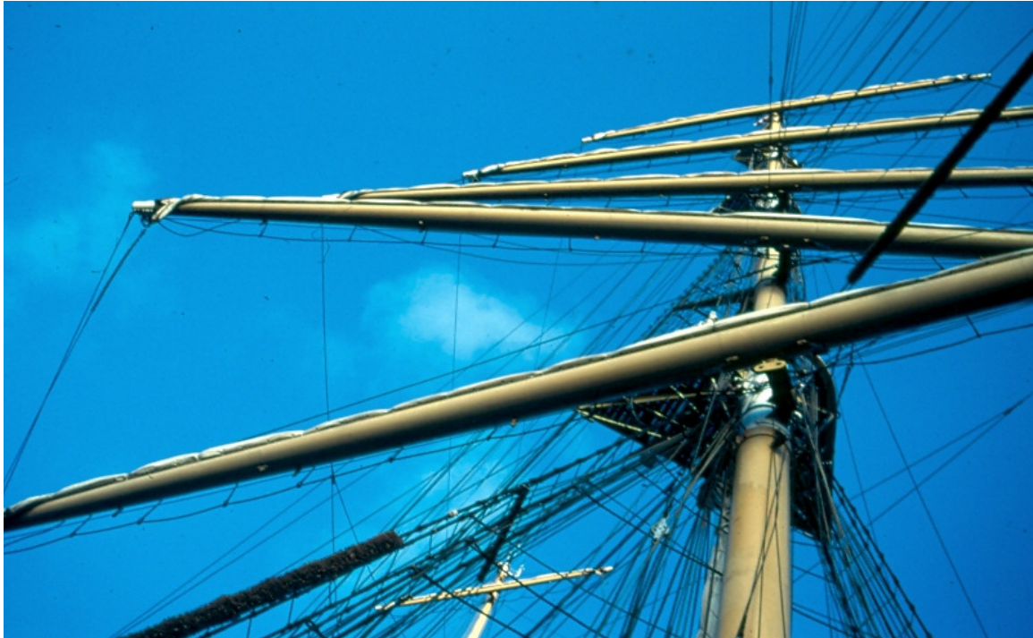
Brassen heißt, die Rahe im Winkel zur Schiffsachse drehen, normalerweise um den Wind besser einfangen zu können
