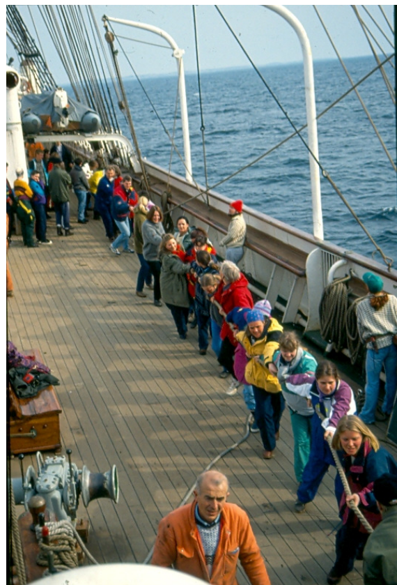
Brassen heißt, die Rahe im Winkel zur Schiffsachse drehen, normalerweise um den Wind besser einfangen zu können
