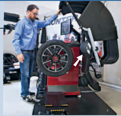
Die Rolle (Pfeil) tastet beim Drehen die Lauffläche ab, prüft so den Rundlauf des Reifens
