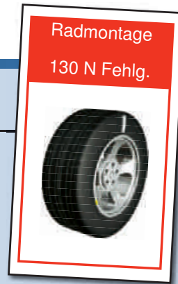
Im roten Bereich: Die Hunter zeigt 130 N und die genaue Stelle am Reifen an
