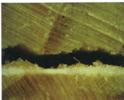
Bild 9: Ergebnis der Untersuchungen zur Scherfestigkeit ungerissener Klebefugen (Statistische Werte: f_{v,mean} = 6,8 \text{ N/mm}^2 f_{v,k} = 4,64 \text{ N/mm}^2 )
