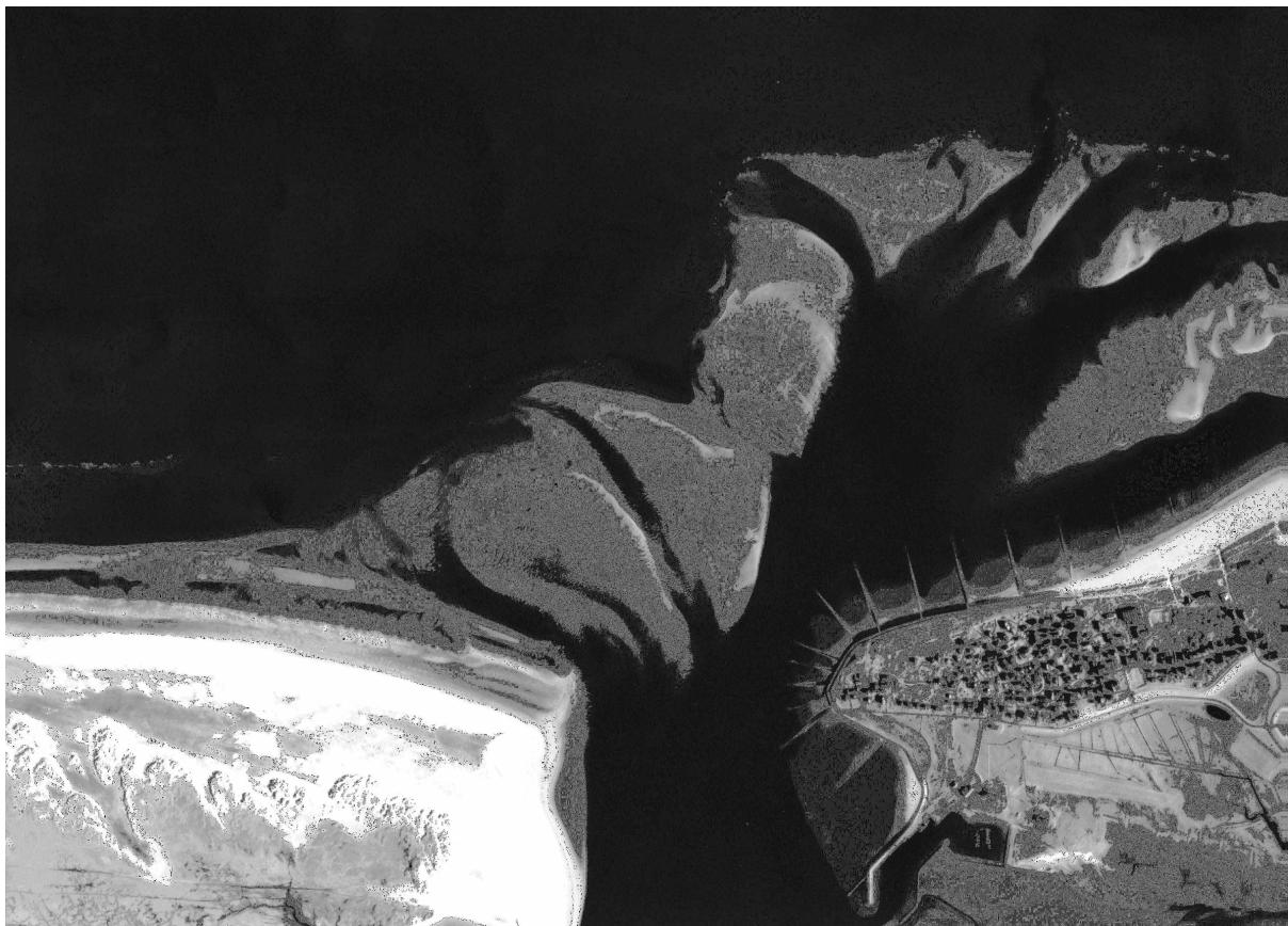
Abb. 2: Ebbdelta des Seegats Wicher Ee mit dem Deckwerke und Bühnen befestigtem Westkopfs Baltrums
