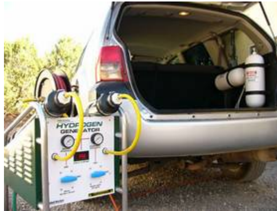
Abb. 59: Mitsubishi Endeavour ausgerüstet mit zusätzlichen CGH2 Tanks mit dem Elektrolyseur zur Betankung [www.switch2hydrogen.com/h2.htm]
