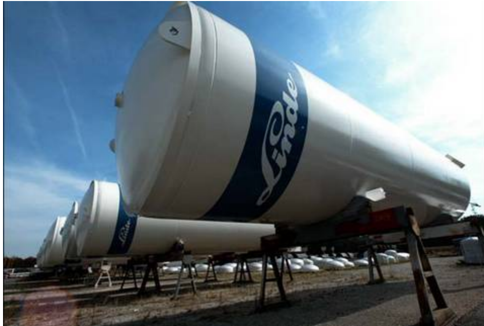
Abb. 28: Große Druckgas-Tanks für Industriekunden, 5-7 MPa, stationär (Foto: Linde AG)
