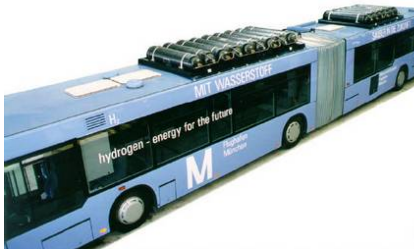
Abb. 30: Dynetek CGH2 Speicher für die MAN Busse am Münchener Flughafen. 15 Einzelbehälter, max. Betriebsdruck 25 MPa, Gesamtgewicht 960 kg, 2,58 m 3
