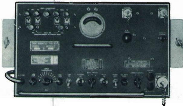
Trasmittitore T14-TRC/1-H 70 Mc - 103 Mc 50 W
