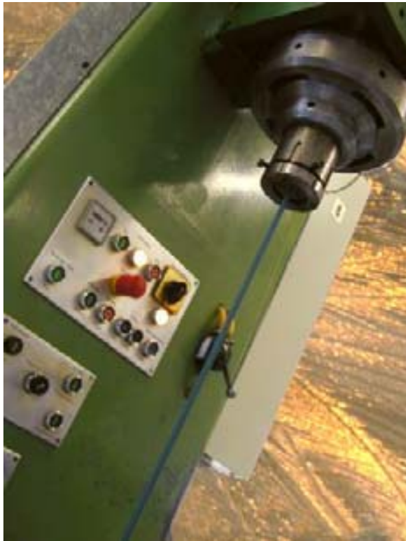
Bild 2: Kolbenpresse für das vertikale Extrudieren von Keramikmassen
