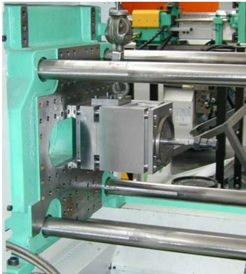
Bild 13: Einbau eines Spritzgusswerkzeugs
