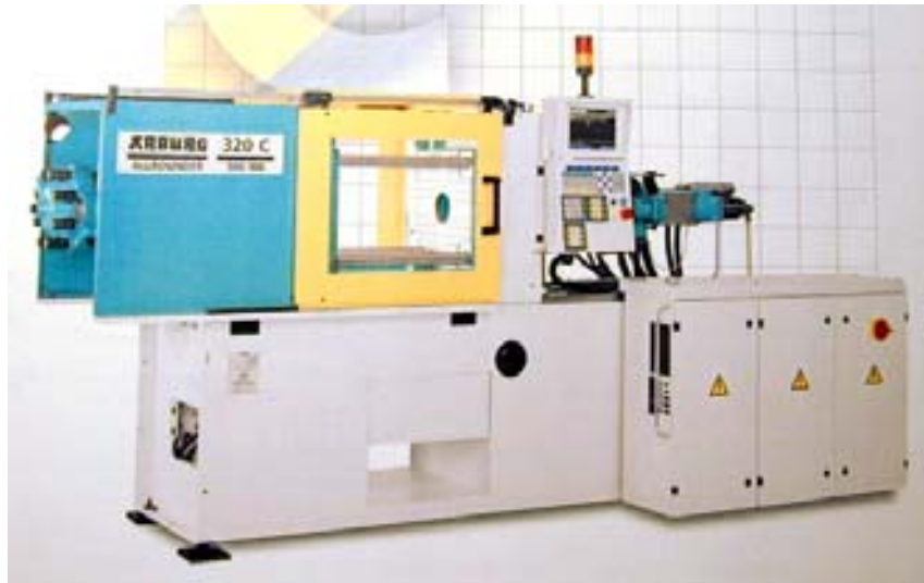
Bild 12: Spritzgussmaschine der Fa. Arburg wie sie bei der Herstellung von Keramikbauteilen zum Einsatz kommt
