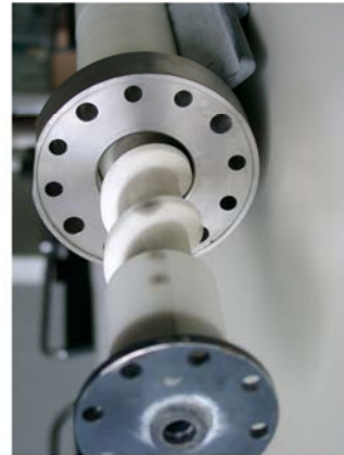
Aktivgelöteter Ti/ZrO 2 -Verbund Schnecke und Zylinder
