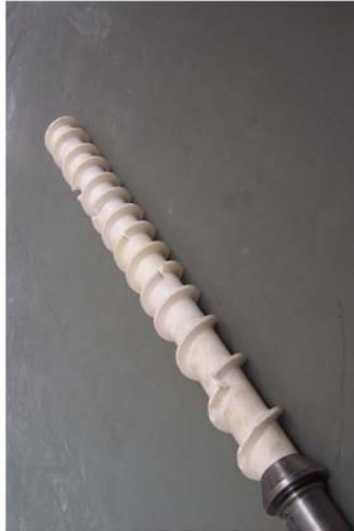
Aufgeschobene Segmente aus Al_2O_3
