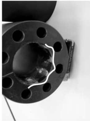
Ausgepresste Welle – Klebung nur an weißen Stellen
