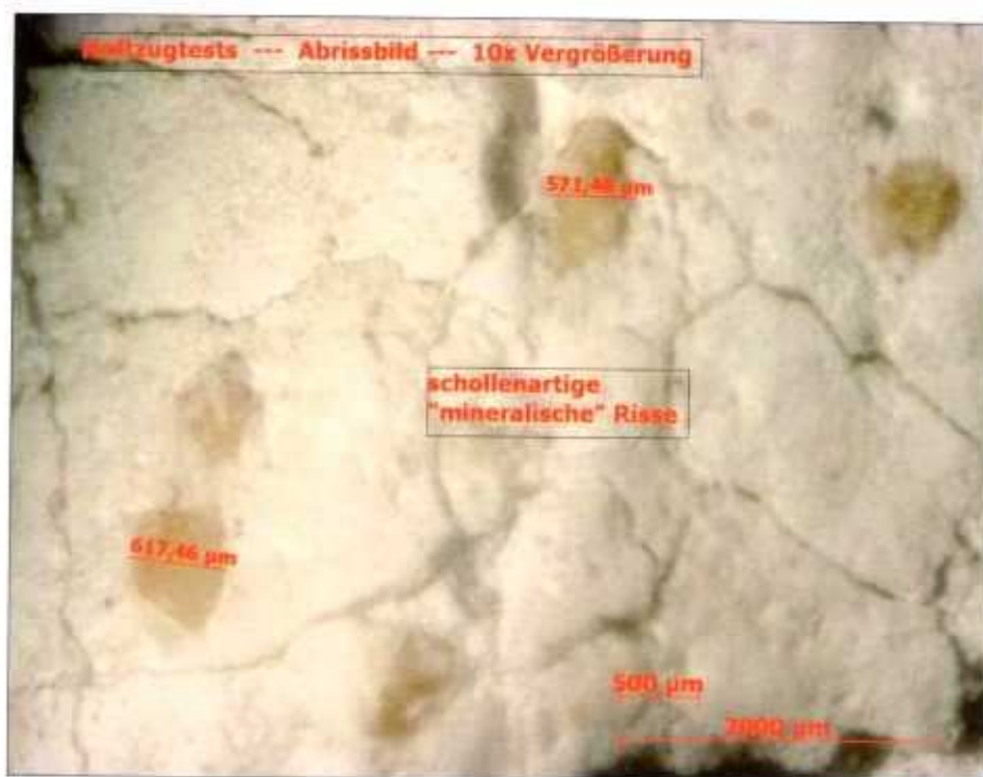
Rückseite von Klebebandtests mit Gipsputzgefüge – Mikroskop
