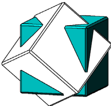
Ein Beispiel ohne verdeckte Kanten und Systemachsen dargestellt und als Axonometrie aufgestellt.
