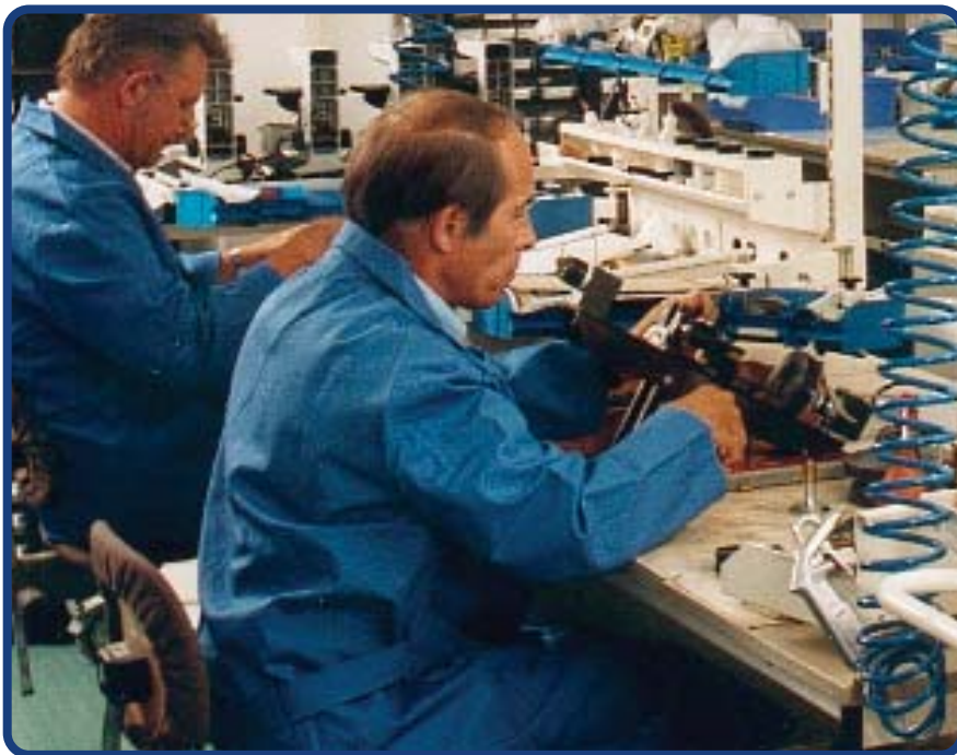
Bei der Montage und Justage der Mikroskope ist absolute Präzision gefordert
