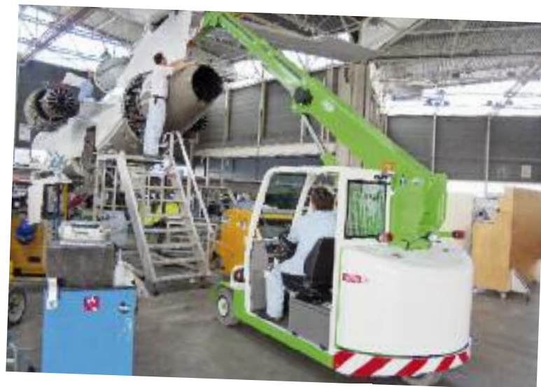
Klassischer Indooreinsatz: Flugzeugwartung mit elektrisch angetriebener JMG-Maschine.
