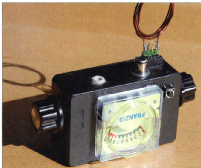
Bild 1: Das Muster des Mini-Tweety ist so groß wie eine Zigaretten-schachtel. Es wird mit einer Mignonzelle betrieben und hat Anschlüsse für Frequenzzähler und Kopfhörer.
