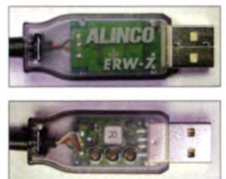
Bild 4 und 5: Das Kabel ERW-7 enthält im USB-Stecker u. a. einen USB-Seriell-FTDI.
