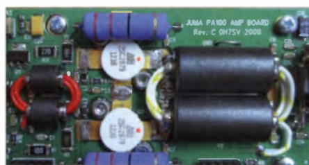
Bild 2: Platine der JUMA PA 100, rechts der Ausgangsübertrager Foto: DL2EWN
