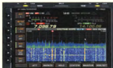
Das Wasserfalldiagramm des IC-7700 bzw. des IC-7800 werden im unteren Teil des Displays dargestellt.
