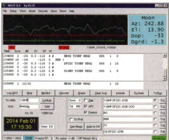
Deutlich zu erkennen bei etwa -110 Hz ist das Echo von YJ0HP. Jede zweite Periode ist dann bei etwa +50 Hz die rechte Spektrallinie der in zwei alternierend gesendete Töne codierten „RRR“ zu sehen.
