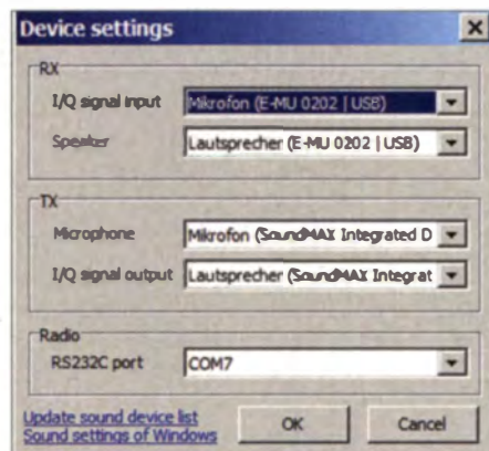
Bild 8: Das Untermenü Device settings enthält wichtige Einträge für die Hardwarezuordnung.
