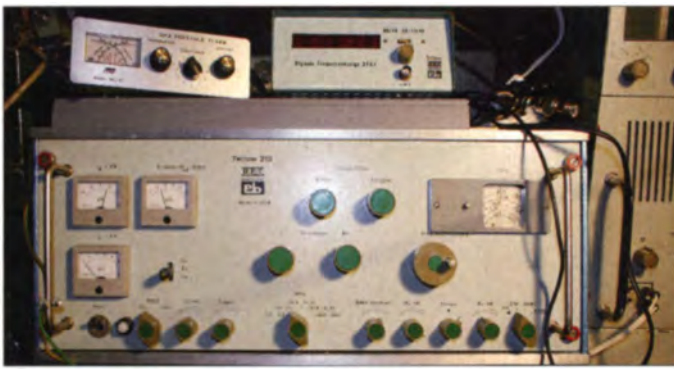
Bild 7: An den Teltow 215D war eine externe digitale Frequenzanzeige, die speziell hierfür entwickelte DFA1, anschließbar (oben in der Mitte).
