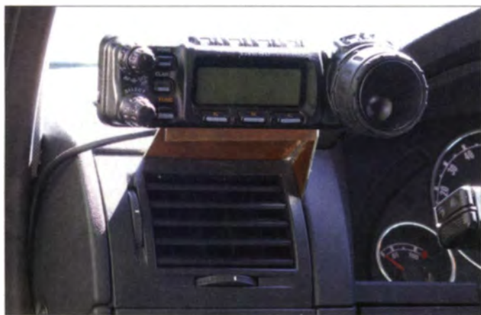
Bild 1: Mit etwas Glück kann man das Bedienteil so unterbringen, dass man den VFO-Knopf direkt neben dem Lenkrad hat.
