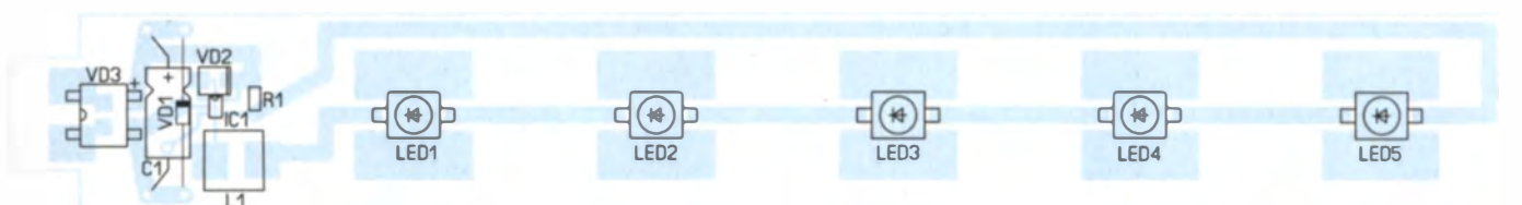
Bild 4: Bestückungsplan der Platine; die LEDs sind unbedingt zur Kühlung auf die umliegenden Flächen aufzulöten.
