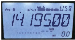
Bild 6 und 7: Nach dem Umschalten mit FUNC und MODE auf SDR lässt sich das Gerät nur noch extern steuern.
