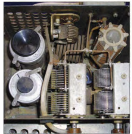
Bild 11: Die Endstufe mit zweimal GU50; für den Anodendrehkondensator musste aus 2 x 500-pF-Typen jeweils die zweite Platte manuell entfernt werden (Spannungsfestigkeit).
