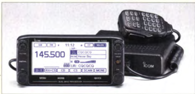
Das monochrome LC-Display des ID-5100E dient gleichzeitig als Touchscreen.
