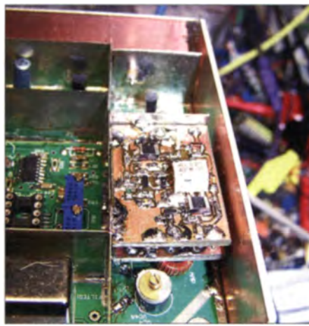
Bild 14: Die beiden Platinen für den neuen bidirektionalen Verstärker lassen sich nach dem Ausbau der alten Schaltung integrieren. Fotos, Screenshots: DK5LV
