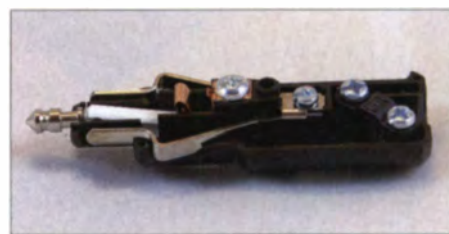
Bild 2: Steckdosen im Auto sind gewöhnlich mit 30 A abgesichert. Die flexible Stromversorgungsleitung zum Handfunkgerät sollte deshalb über einen Stecker mit eingebauter Sicherung angeschlossen werden (hier: 8 A).
