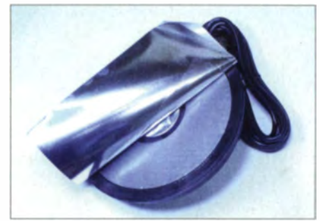
Bild 4: Eine Folie unter dem Magneten gibt dem Magnetfuß die nötige kapazitive Verbindung zum Autoblech (Sirio 145PL).
