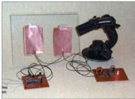
Bild 4: Bei diesem Experiment zur Energieübertragung nach dem kapazitiven Verfahren wird eine LED mit Strom versorgt.
