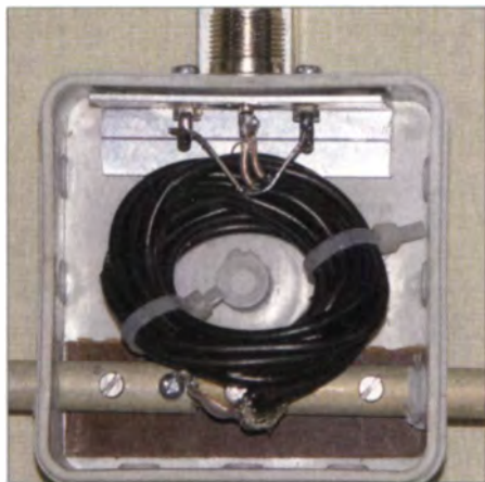
Bild 5: Die Impedanzdrossel mit zweimal RG174-Kabel
