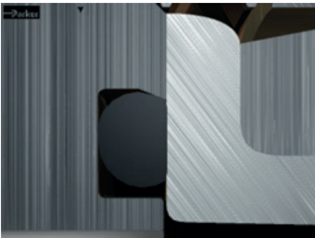
Nach dem Anzug der Überwurfmutter Anstelle von „Trap Seals“ können standardmäßige O-Ringe verwendet werden.
