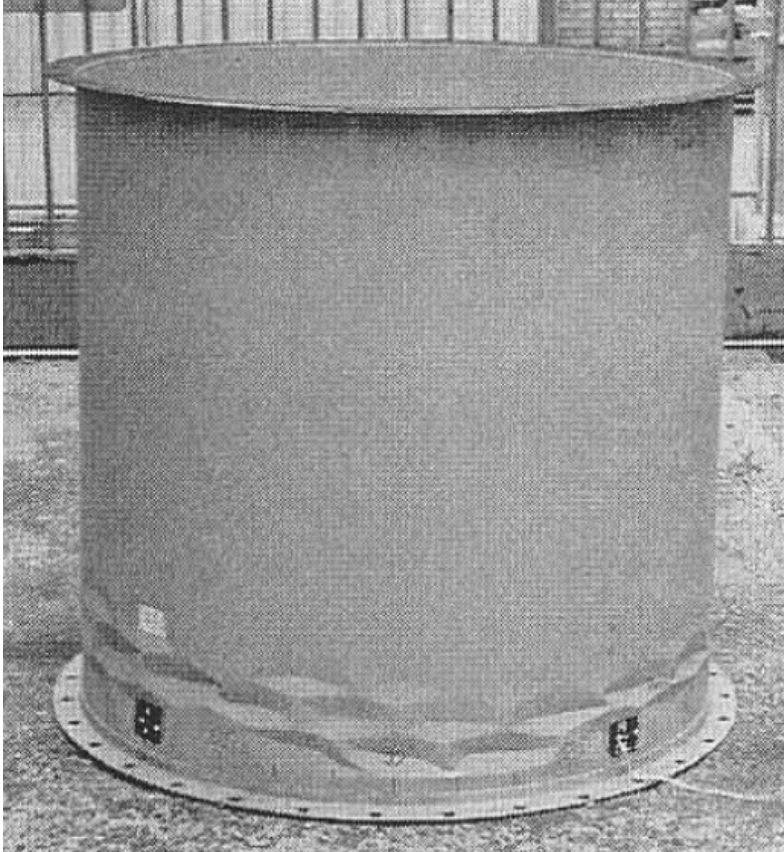
Bild 4-8 Versagensfigur Meridianbeulen, Knödel, P.: Stabilitätsuntersuchungen an kreiszylindrischen stählernen Siloschüssen. Dissertation, Universität Karlsruhe 1995.
