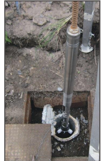
Abb.4: Darstellung der Messausrüstung und Einbau. Unten: Messsonde mit Blendenaufsatz
