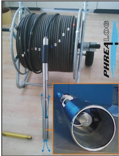
Messsonden und Blick in die Messzelle
