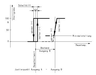
Das Diagramm veranschaulicht die Bedeutung der Einstellknöpfe: Hauptsollwert – Justierpunkt des Zweipunktausgangs A, Abstand - Justierpunkt des Stetigausgangs B bezogen auf den Hauptsollwert, Minimalstellung – Mindestöffnung der Außenluftklappe/Ausgang B.
