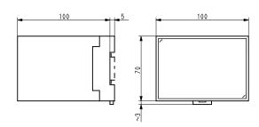
Die Geräte sind für Wandaufbau und Fronteinbau geeignet. Wandaufbau ist durch Aufschnappen auf eine 35mm-Tragschiene oder durch Schraubbefestigung möglich. Für Fronteinbau ist ein Montagezubehör Typ 999.401 erforderlich.
