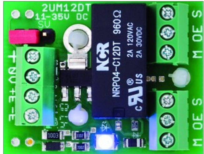
Die Relaisplatine 2UMDT-S sieht ähnlich aus wie die Platine 2UM12DT (Foto).
