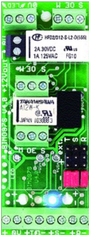
BIMO97SG V 4.0 mit bistabilem Relais
