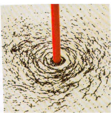
Bild 4 Kreisförmige Ausrichtung von Eisenspänen um einen Stabmagneten
