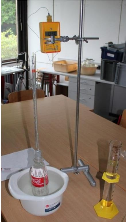
Eine einfach herzustellende Messapparatur besteht aus einer bis zum Rand mit (angefärbtem) Wasser gefüllten Flasche aus Glas oder festem Kunststoff, einem durchbohrten Stopfen, einer Messpipette und einem Thermometer.
