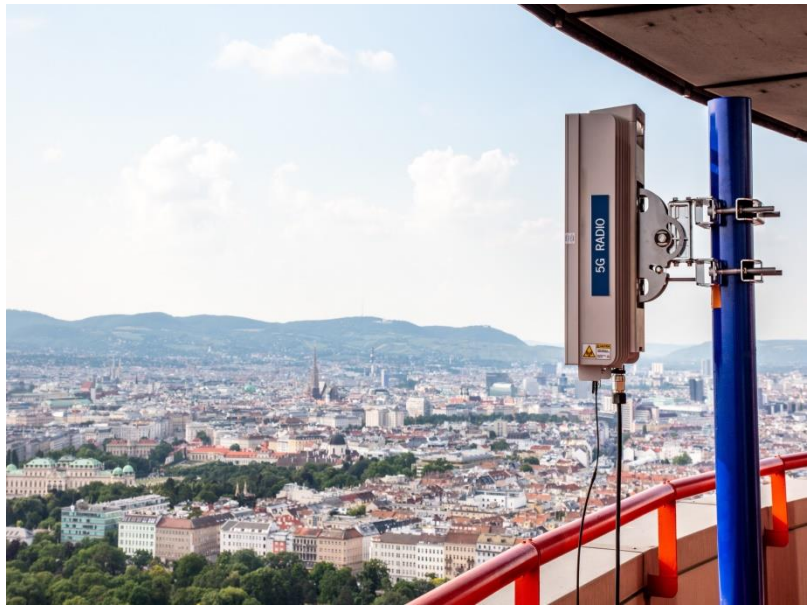
Foto von A1: 5G Mobilfunkzelle im A1 Technologiezentrum Wien Arsenal
