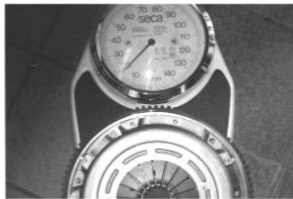
Schwungrad mit Tellerfederkupplung auf der Waage
