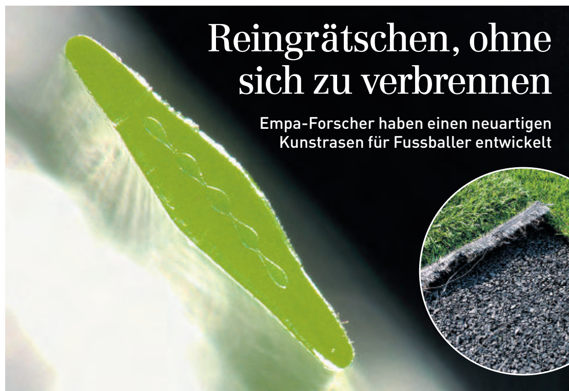
Querschnitt des neuen Produkts: Fünf harte Kerne, umgeben von einer weichen Hülle
