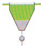
Abb. 26 Dortmund-Becken Quelle: Informationsbroschüre zum Klärwerk Ruhleben, Berliner Wasserbetriebe
