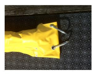
Der lose Verbindungsteil am Elementende lässt sich so umklappen, dass für das Ziehen der Oelsperre auf dem Wasser oder uferseitig ein zugsicheres und geschütztes Sperrenende ausgebildet werden kann. Ansicht zeigt die Sperre mit Schwimmkörper-Durchmesser 15 cm.
