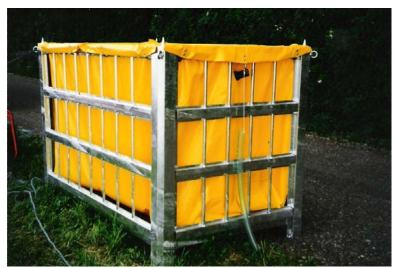
Als Alternative zu bekannten Haspelsystemen lässt sich die flexibel positionierbare Oelsperre der 4. Generation gut im stapelbaren Universal-Container (mit auffangdichter Innenplane) lagern. Das Lagern von bis zu 60 m Oelsperren d 22 cm ist pro Container möglich (Masse: B 1.20x L 2.20x H 1.40).
