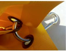
Ausbildung loses Elementende der WU-Zurrgurt-Oelsperre mit innenliegend geschütztem Zurrgurt und Edelstahl-Triangel und deckungsgleichen Rundösen für das Durchführen der Karabiner. Zum Verbinden werden die losen Elementende ineinandergeschoben und mit den Karabinern gesichert.
