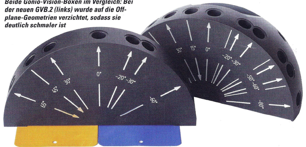
Beide Boxen sind ideale Werkzeuge zur visuellen Überprüfung von Musterblechen. Die Überprüfung von Messwerten ist exakt möglich, da die Geometrien entsprechen
