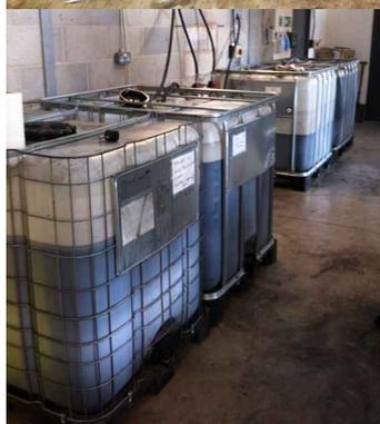
*Die Fotos zeigen Proben aus einem Testlauf des Pyro-BAF-Reaktors am 15. August 2012. Als Biomasse wurde Miscanthus eingesetzt, als ölhaltiger Stoff Glycerin verwendet. Mit annähernd 180l/Stunde wurden über 2000l Öl erzeugt. Der Energiewert des erzeugten Brennstoffs ist mit 11,8 kW/kg dem von Kerosin vergleichbar. Das Öl ist ohne weitere Aufbereitung in BHKWs verwendbar.*
