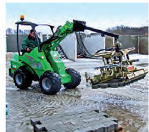
Hydraulische Verlegezange am Minilader
