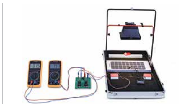
Temperaturabhängigkeit der Leistung von Solarmodulen
