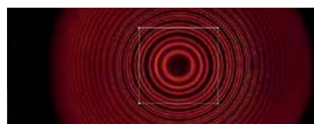
Abb. 4: Horizontaler Zeeman-Effekt: Beobachtung der Triplet-Aufspaltung der roten Cadmium-Linie in einem externen Magnetfeld.
