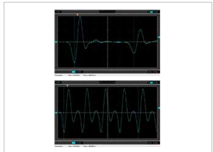
Abb. 3: Ausbreitung eines Schallimpulses (oben: PVC-Stab, 200 mm, unten: Glasstab, 200 mm), Signal an dem der Erregung gegenüberliegenden Stabende (cyan)
