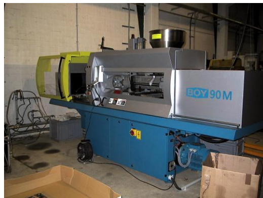
Alle Prototypen werden in den betriebseigenen Spritzgießmaschinen gefertigt.
