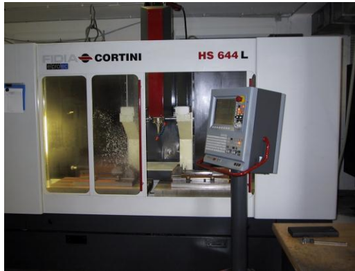
Mit dieser Fräsmaschine lassen sich entweder große Bauteile oder mit Hilfe von zwei Aufspannungen gleichzeitig zwei Werkstücke bearbeiten.
