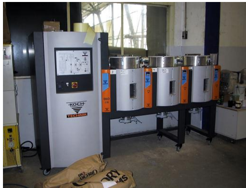
Das dem Serienmaterial entsprechende Kunststoffgranulat wird vor der Verarbeitung in der Trocknungsanlage auf die exakte Feuchtigkeit gebracht.
