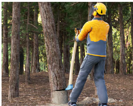
Hängengebliebenen Baum mit dem Sappie vom Stock hebeln;
