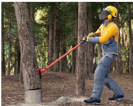
Hängengebliebenen Baum mit dem Fällheber oder Wendehaken abdrehen (dabei den Fällheber/Wendebaum nur auf Zug bedienen);
