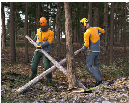
Hängengebliebenen Baum mit ausreichend dicken Hölzern (über Kreuz und zu zweit) weghebeln; aber Vorsicht, sich nicht unter den hängengebliebenen Baum stellen und prüfen, ob der Baum sicher zwischen zwei Bäumen festliegt;
