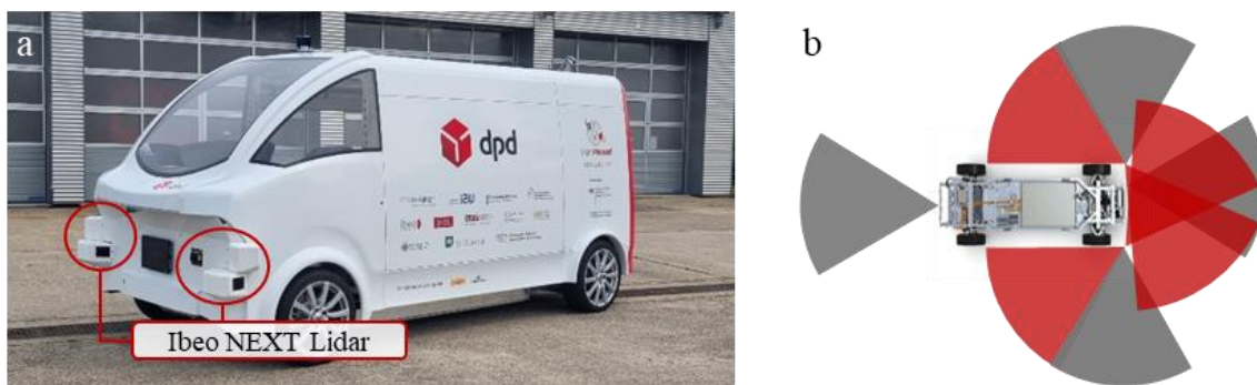
Abbildung 4: Versuchsträgers PLUTO (a) für den Anwendungsfall der Paketlogistik und (b) verwendetes Laserscannersetup.
