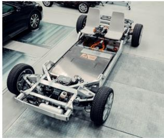
Abbildung 2: HFM Motionboard als Grundlage für den Versuchsträger PLUTO
