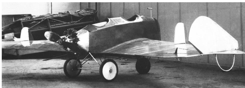
Die Soldenhoff A/5 erhielt zur Verbesserung der Seitenstabilität als erste Maschine zusätzliche Flossen auf den Flügelspitzen. Die Seitensteuerung mit den vertikalen Spreizklappen blieb davon unberührt.
