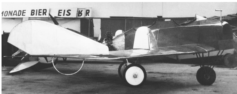
Die Soldenhoff A/5 erhielt zur Verbesserung der Seitenstabilität als erste Maschine zusätzliche Flossen auf den Flügelspitzen. Die Seitensteuerung mit den vertikalen Spreizklappen blieb davon unberührt.
