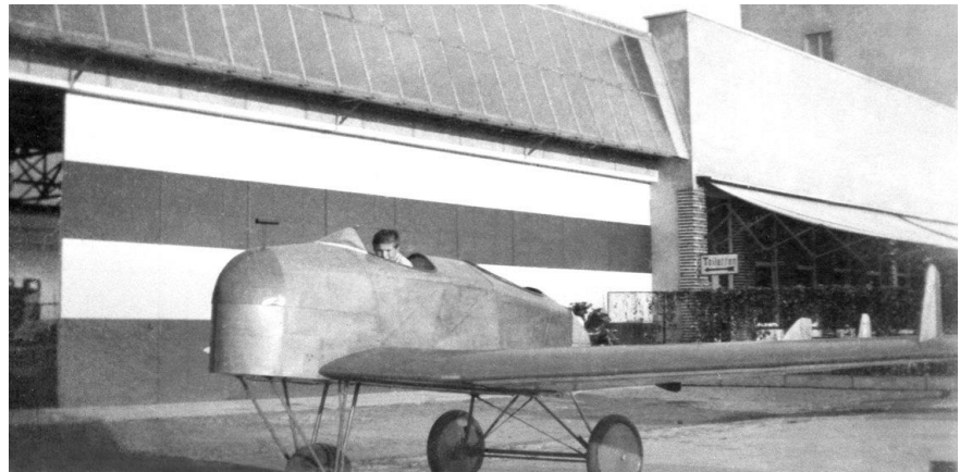
Das geänderte Fahrwerk der A/4 mit Bugrad und dem Hauptfahrgestell unter dem Heck.
