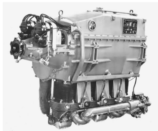
Vierzylinder-Reihenmotor Argus As 8
