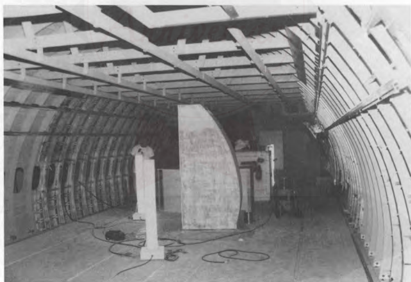
Links sieht man den vorderen Rumpfeinschub, der das ehemalige DC-10-mock-up auf MD-11 Länge bringt.
