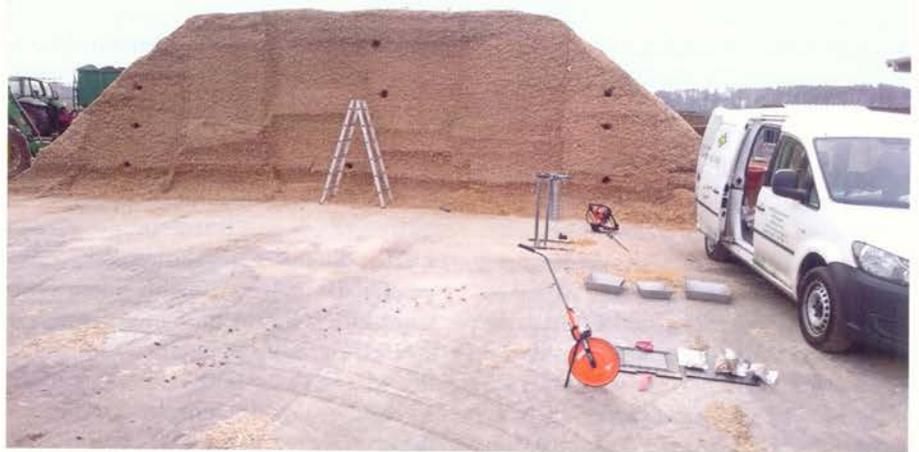
Mit „schwerem Gerät“ wurden an definierten Positionen Bohrkern aus den Silostöcken entnommen.
