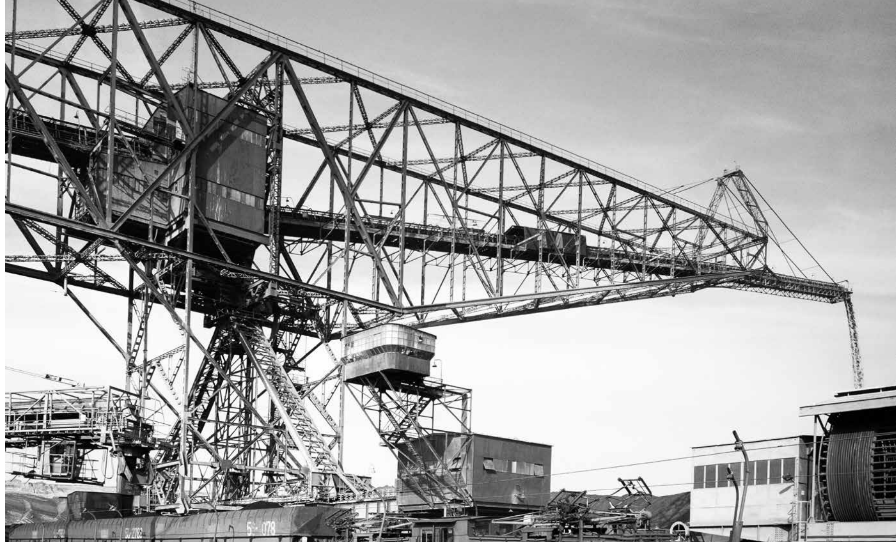
Beladung eines Kohlenzuges im Tagebau Zwenkau unterhalb der Abraumförderbrücke AFB F45-18 „Böhlen II“, 1996
