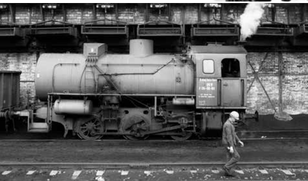
Feuerlose Lokomotive F-174 am Siebkohlen- bunker der Brikettfabrik Holzweißig, 1993
