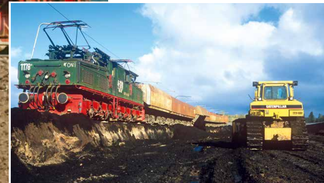
Abraumzug mit EL 2 an der Kippstelle zur Sanierung einer Säureharzdeponie im Geiseltal, 1997 Kohlenzüge mit Werkbahn-Lokomotiven EL 2 bei der Beladung im Kohlenbunker des Tagebaus Zwenkau kurz vor der Stilllegung, 1999
