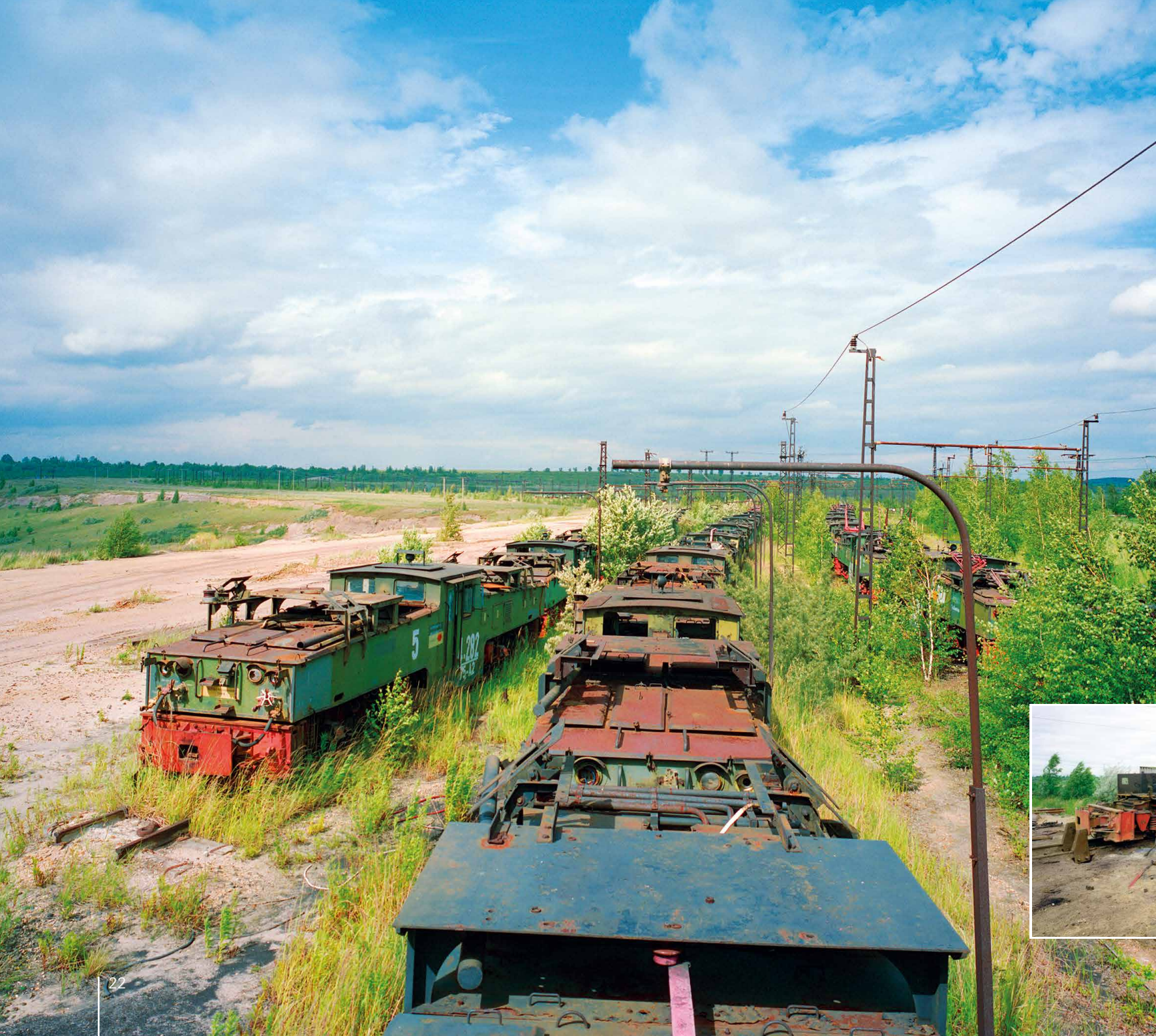
900 mm-Grubenlokomotiven der Bauart EL 3 warten auf einem Lokfriedhof nahe der Tagesanlagen Kahnsdorf des Tagebaus Witznitz II auf die Verschrottung, 1996
