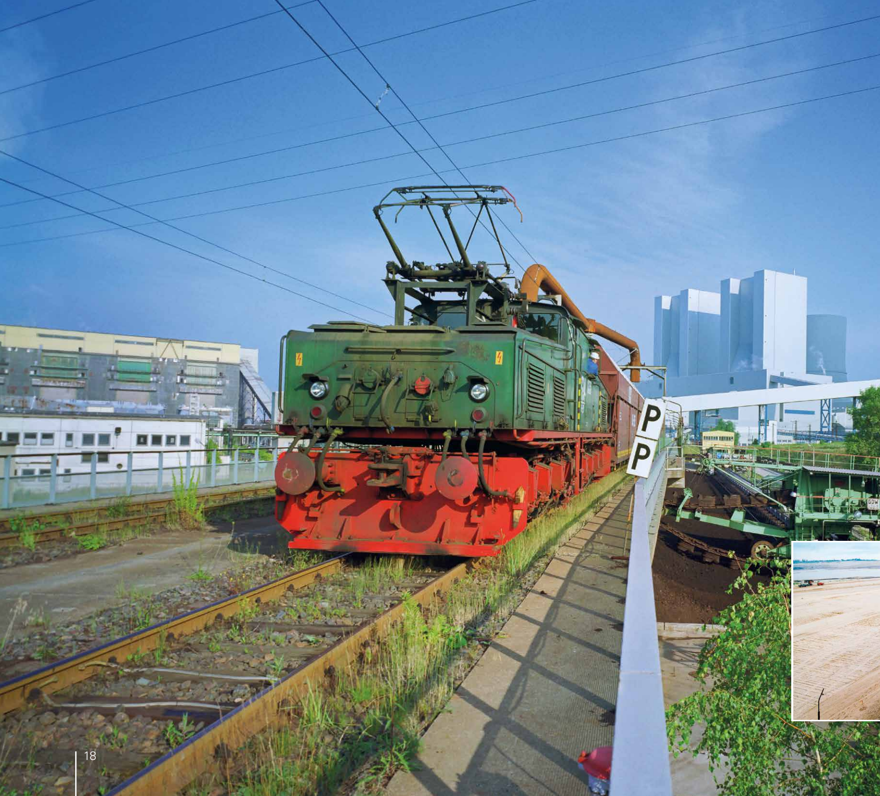
Kohlenzug der LMBV, bespannt mit einer Grubenlokomotive EL 2, beim Kippen von Kohle auf dem Grabenbunker des Alt-Kraftwerks Lippendorf der VEAG, rechts im Bild: das Neubau-Kraftwerk der VEAG im Anfahrbetrieb, 1999
