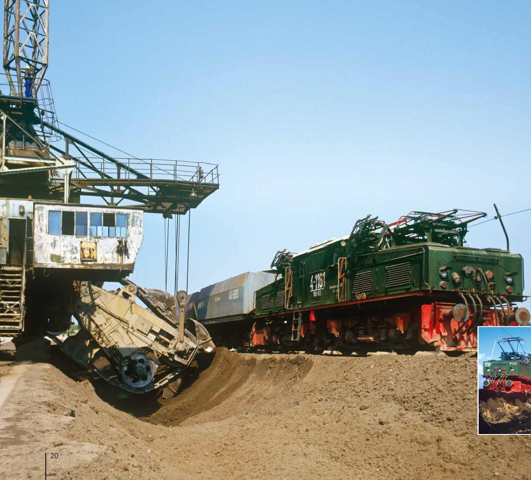
Grubenlokomotive EL 2 mit Abraumzug am Absetzer As 1600-1025 im Sanierungstagebau Golpa-Nord, 1994
