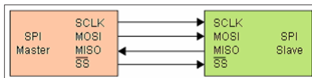
Abb. 12.10: Einfache Konfiguration eines SPI BUS
