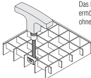
Das Positionierwerkzeug 17 33 60 ermöglicht eine Montage von oben, ohne eine Demontage des Gitterrostes.
