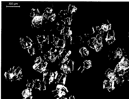
Abb. 14: NTO-Kristalle mit Ultraschall
