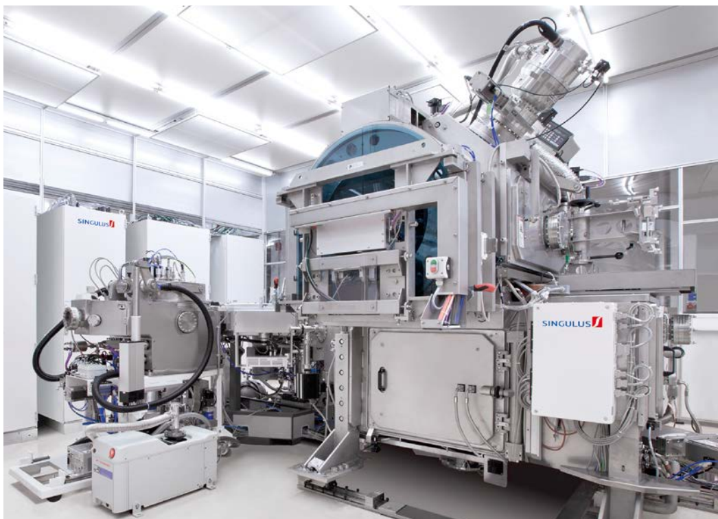
TIMARIS Ultra-Hochvakuum- Beschichtungsanlage für die Halbleitertechnik.
