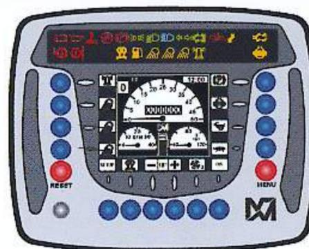
des Getriebes und des Elektrosystems angezeigt. Damit kann er stets den augenblicklichen Betriebszustand seiner Maschine genau erkennen und sofort im jeweils erforderlichen Maße reagieren. Die Tachometer-, Drehzahl-, Betriebsstunden- und Füllstandsangaben werden zum schnelleren Erkennen in analoger oder digitaler Form auf dem LC-Bildschirm angezeigt. Im Aufzeichnungsmodus
