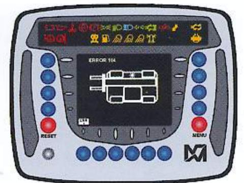
speichert MERLIN als "Black Box" alle Steuer und Funktionsdaten der Maschine, so dass im Bedarfsfall das Instandhaltungspersonal schnell die Bedien- und Funktionsdaten der Maschine wieder aufrufen, kontrollieren und erkennen kann.
