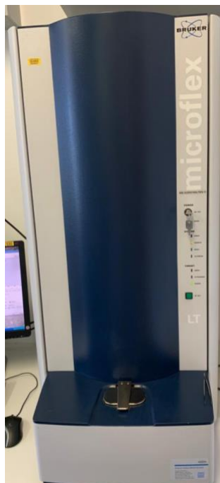
Abb.5: Bild eines MALDI-TOF wie es in der Routinediagnostik verwendet wird.
