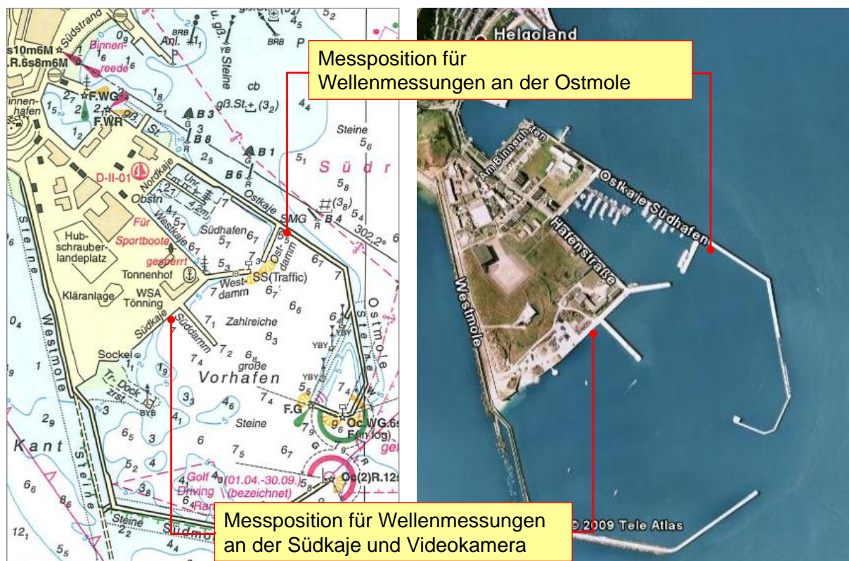
Abbildung 3-1: Messpositionen an der Südkaje und an der Ostmole
