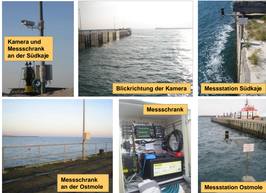
Abbildung 3-3: Fotos der Messlokationen an der Südkaje (oben) und an der Ostmole (unten)
