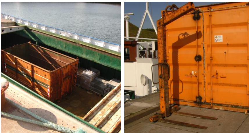
Abbildung 2-23: Palettengabel (rechts) zur Bestückung des Laderaums mit palettierten Stückgüter (links)
