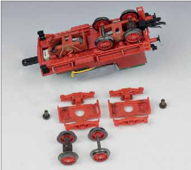
Der Antrieb erfolgt auf die beiden äußeren und mit Haftreifen versehenen Achsen. Die inneren Achsen sind deutlich erkennbar höhenvariabel gelagert. Alle Achsen dienen zur Stromaufnahme.
