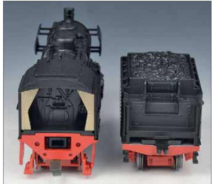
Wie ein Normschacht wirkt die Kupplungsaufnahme auf der Lokomotivseite. Sowohl Kupplungsdeichsel als auch deren Aufnahme sind kullissengeführt und ermöglichen so den geringen Abstand. Fotos: dh
