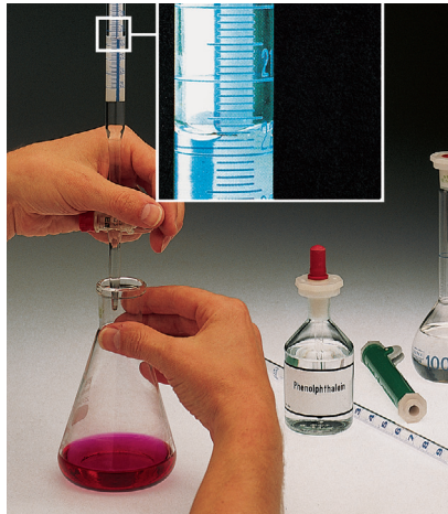
B1 Titration mit Phenolphthalein als Indikator. Der blaue Schellbach-Streifen an der Bürette hilft beim genauen Ablesen (hier z.B. 21,8 ml)
