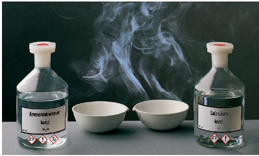
B1 Ammoniak und Chlorwasserstoff reagieren zu Ammoniumchlorid (links). Das Chlorwasserstoff-Molekül gibt ein Proton an das Ammoniak-Molekül ab (rechts)
