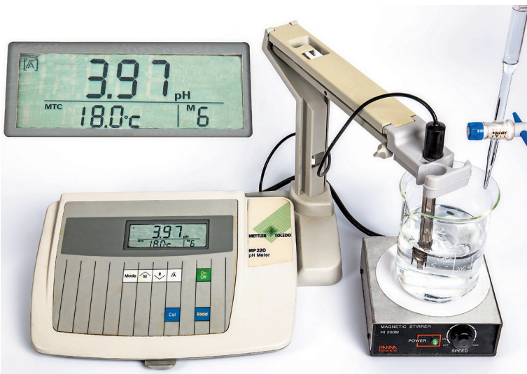
B1 Arbeitsplatz für die Durchführung und Auswertung einer pH-metrischen Titration
